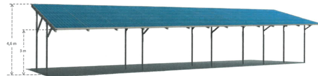
Figure 1 : Schéma de principe d'une structure surélevée
